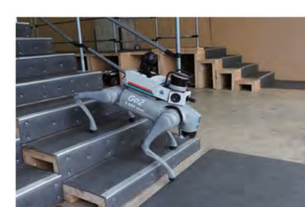
図2 極限での運動性もテスト 共同開発者のFactorial Roboticsが1階に設置されたコースを駆け、近接センサーやカメラなどもテストしている。
